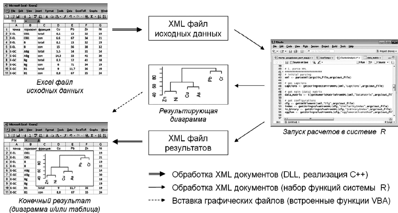
Рис. 1. Схема взаимодействия Excel с пакетом R через XML файлы, реализованная в надстройке ExcelToR.
