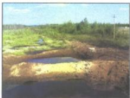
Фото 7. Фрагмент амбара факельной площадки с газоконденсатными шламами. В отличие от нефтешламов конденсатные шламы имеют достаточно стабильный состав углеводородов, что на этапе разработки технологии значительно облегчало задачу по их деструкции.
