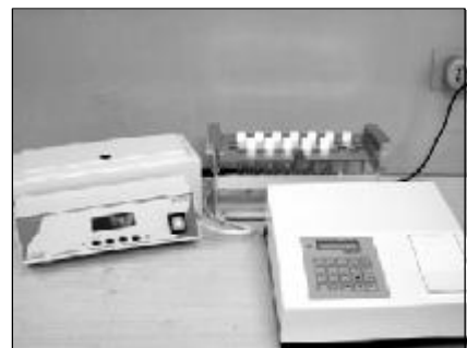
Рис. 2. Термоблок, штатив с виалами и анализатор жидкости «Флюорат-02» для измерения ХПК водных сред.
