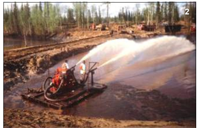
Фото 2. Уборка нефти с водной поверхности с помощью аэролодок (1) и гидронасосов (2).
