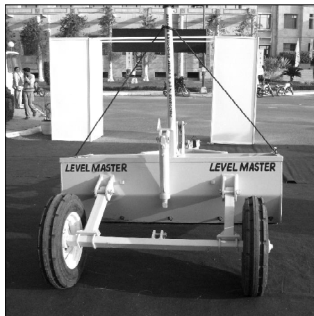
GPS-станция, применяемая для выравнивания поверхности почвы.
