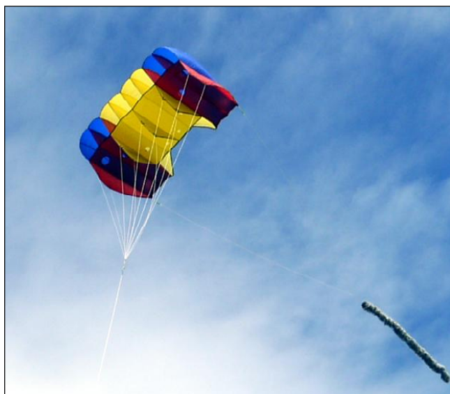
Рис. 1. Змей типа «параfoil», использованный для подъема фотооборудования на высоту.
