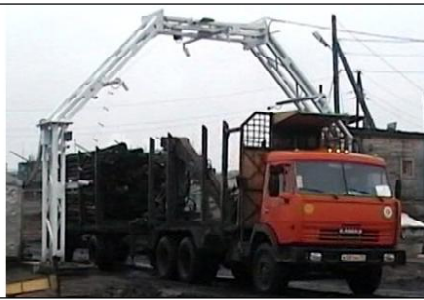
Внешний вид опытной установки для измерения объема круглых лесоматериалов для целей таможенного контроля. Руководитель группы разработчиков – к.б.н. З.П. Мартынюк.
