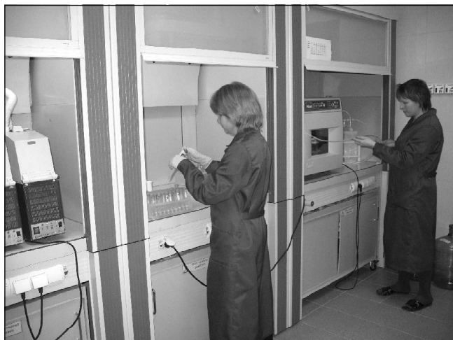
Современные методы пробоподготовки с использованием микроволновых минерализаторов.
