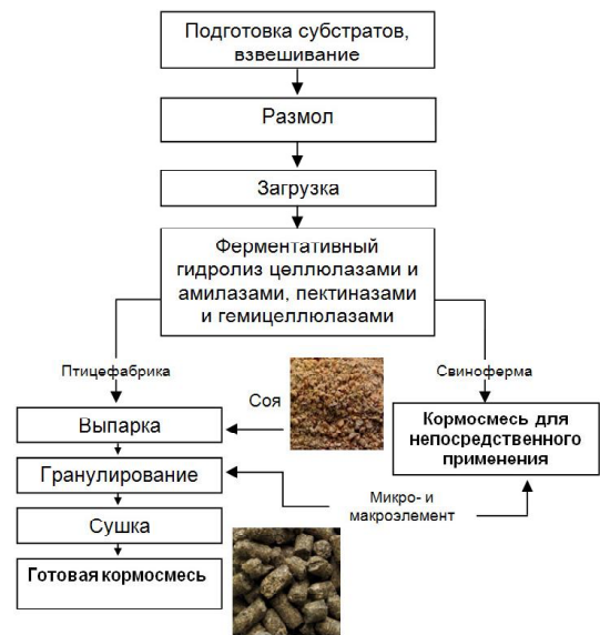
Рис. 1. Технология более рационального применения полиферментных препаратов гидролаз.
