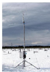
Комплексы газометрического оборудования LI-COR для измерения потоков углекислого газа методом микровихревых пульсаций
