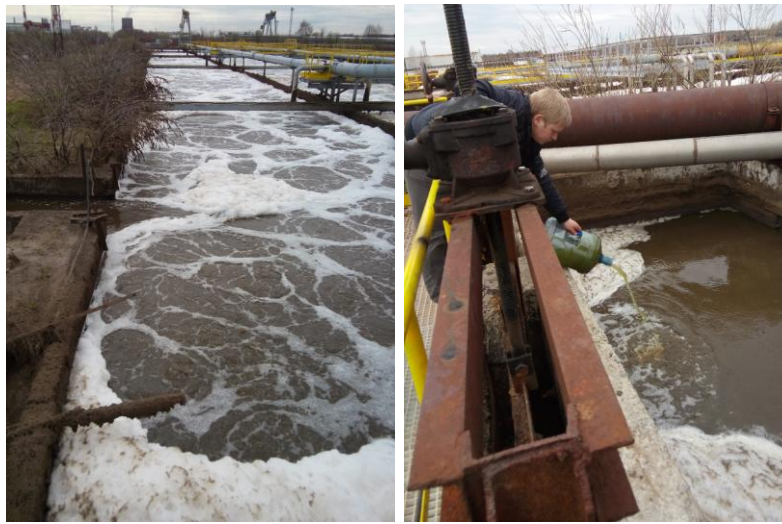
Внесение микроводорослей Chlorella vulgaris в аэротенки АО «Монди СЛПК»
