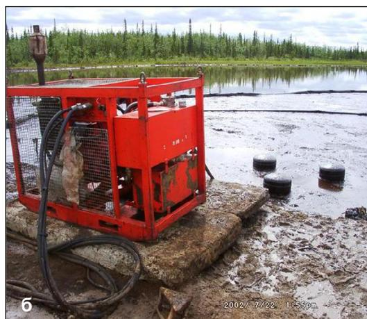
Фото 5. Установка «Дезми» состоит из насоса на поплавках (а) и силового блока (б).
