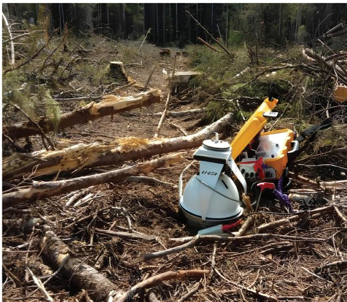
Измерение эмиссии CO<sub>2</sub> с поверхности почвы на вырубке с использованием газоанализатора LI COR 8100.
