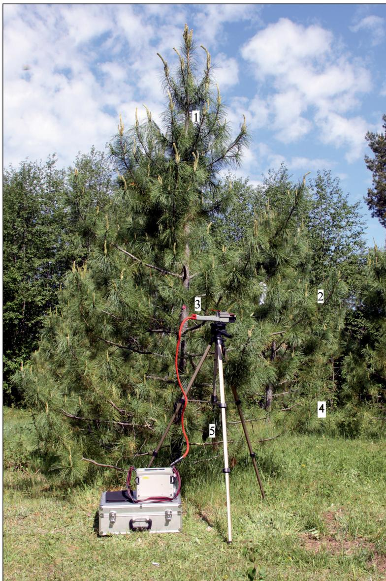
Фото 6. Определение видимого  $\text{CO}_2$ -газообмена и транспирации хвои кедра европейского газометрической системой LCPPro+ (Англия). Цифрами обозначены места отбора проб хвои для биохимического анализа пигментов и определения  $\text{CO}_2$ -газообмена, транспирации (УОХ «Междорское», 2 июня 2010 г.). Фото И.В. Далькэ.
