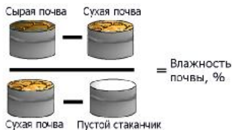
Рис. 1. Схема определения влажности почвы [4].
