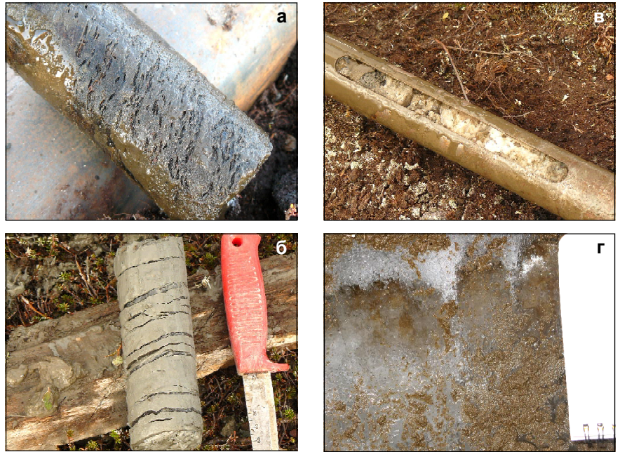
Рис. 4. Текстура мерзлых пород: мелкошлировая криотекстура мерзлого торфа (а), косослоистая криотекстура суглинков (б), ледогрунт (в), инъекционный лед гидролакколита (г).
