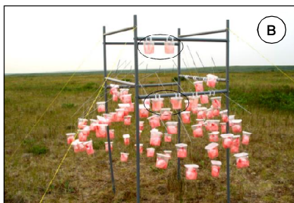
Установка контейнеров в пологом леса с пластинчатыми (а) и порошковыми (б) сорбентами и пример организации сбора сухих аэрозолей в тундре (в): контейнеры с порошковыми сорбентами крепятся на поперечинах (выделены контуром), а пластинчатые – развешиваются на консолях.
