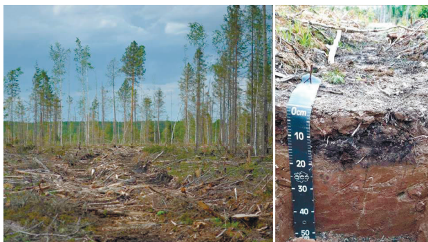
Рис. 26. Общий вид участка 10П (слева) – волок с десятью проходами тяжелой техники и профиль турбозема детритного (справа).
