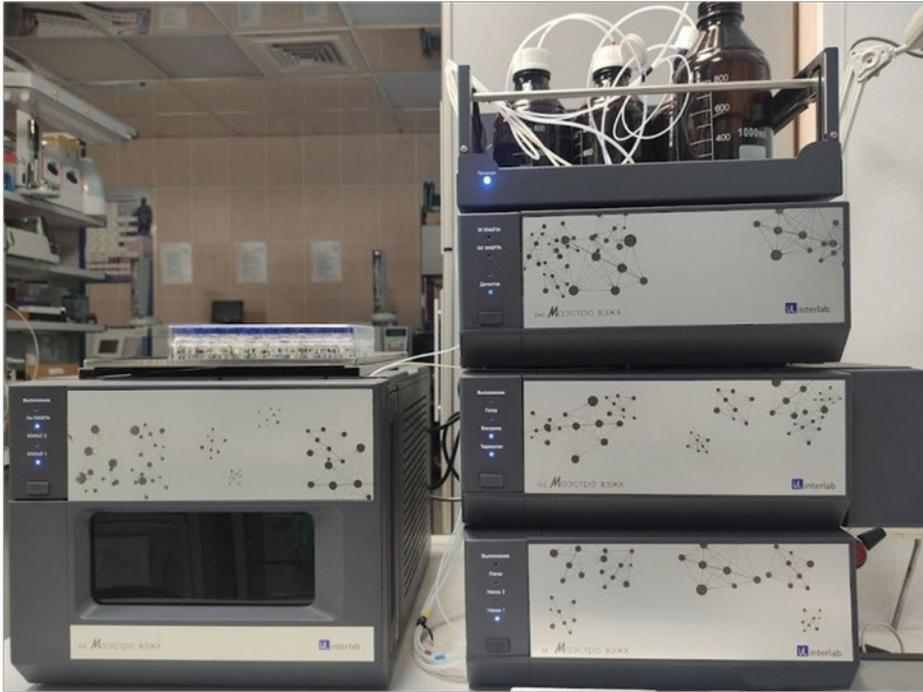
В настоящее время в отделе почвоведения с использованием высокоэффективного жидкостного хроматографа «Маэстро» проводят исследования аккумуляции и распределения полициклических ароматических углеводородов в бугристых торфяниках и растениях тундровой зоны
