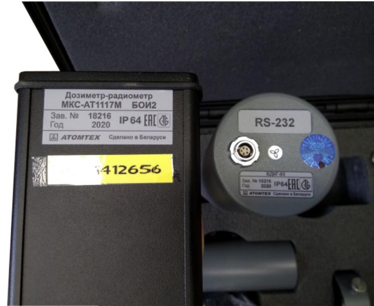
Предназначен для измерения характеристик непрерывного излучения и оперативного поиска источников ионизирующих излучений и радиоактивных материалов.
