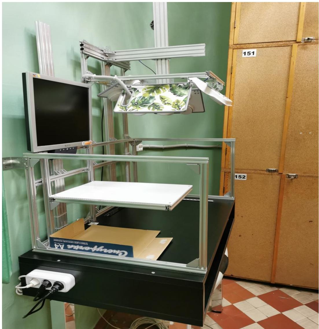
Рисунок 2 – Внешний вид установки для оцифровки гербарных листов
