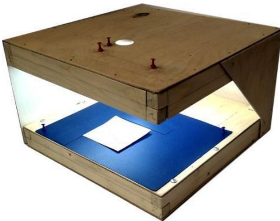
Рисунок 1 – Самодельное устройство для фотографирования этикеток с помощью смартфона
