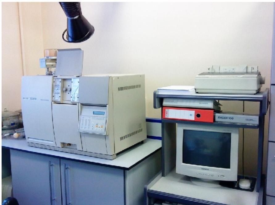
Анализатор предназначен для одновременного определения массовой доли углерода, водорода, азота, серы и кислорода, содержащихся в органических и неорганических химических соединениях и веществах различной природы и происхождения.
