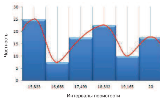
Рис. 2. Изображение полимодального закона распределения на примере значений пористости.
